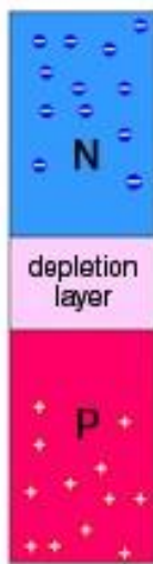
Slika 2.3: pn-spoj in področje električnega polja na sredini [3].
